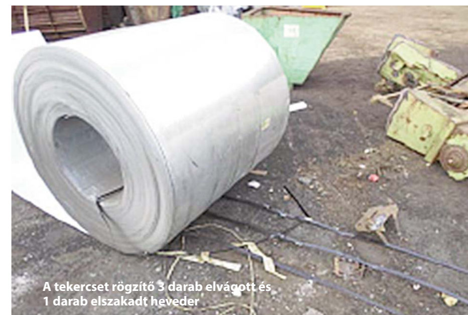
A balesetet okozó acéltekercs hevederekkel rögzítve
