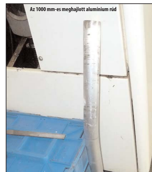
A megtoláshoz használt alumínium rúd a főorsó végében maradt
